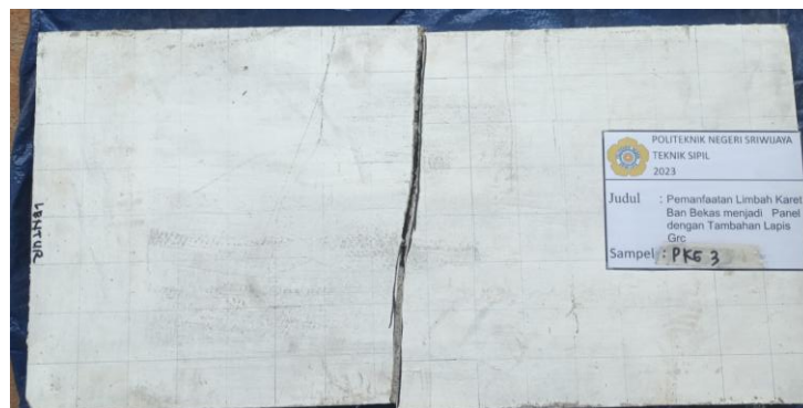
Gambar 5. Pola Retak Pada Campuran Karet tambahan GRC untuk Pengujian Kuat Lentur
