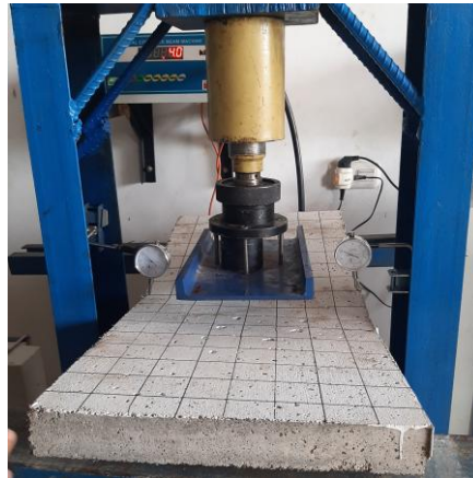
Gambar 3. Pengujian Kuat Lentur Panel Dinding
