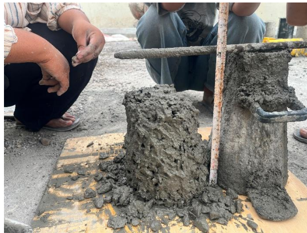
Gambar 1. Proses pengujian Slump
