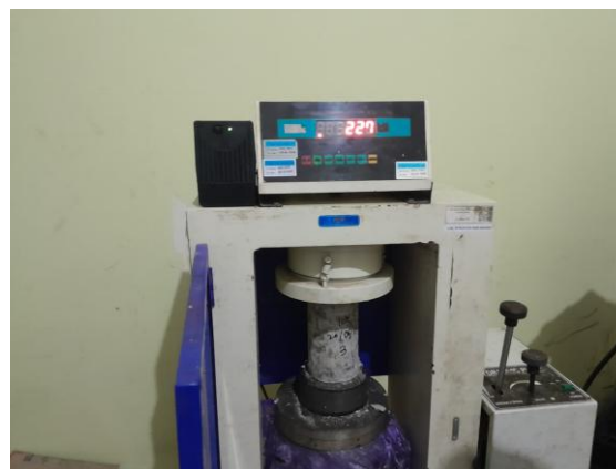
Gambar 3. Proses pengujian kuat tekan
