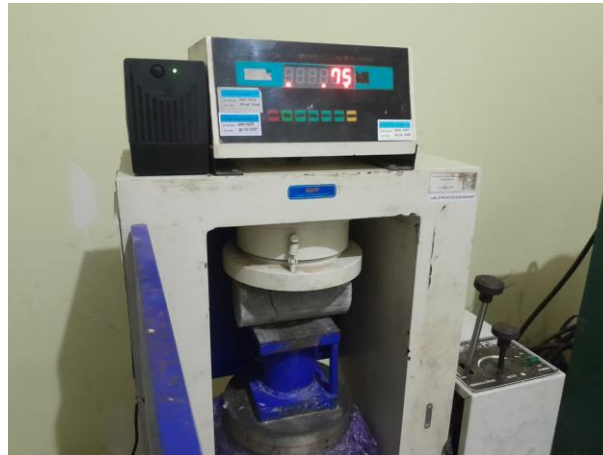
Gambar 4. Proses pengujian kuat tarik belah
