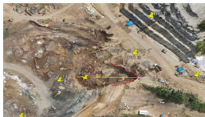
Gambar 4. Retak Mahkota dan Arah Longsoran
