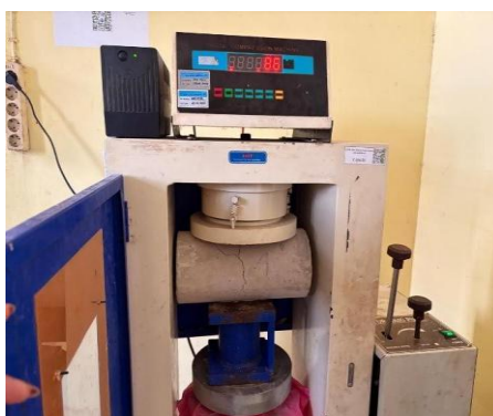
Gambar 5. Proses Pengujian Kuat Tarik Belah
