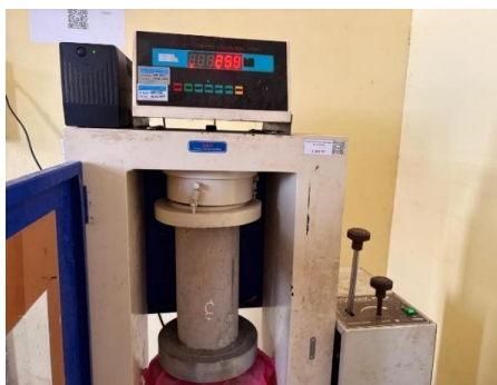
Gambar 4. Proses Pengujian Kuat Tekan
