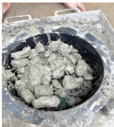
Gambar 2. Proses pencampuran kawat loket
