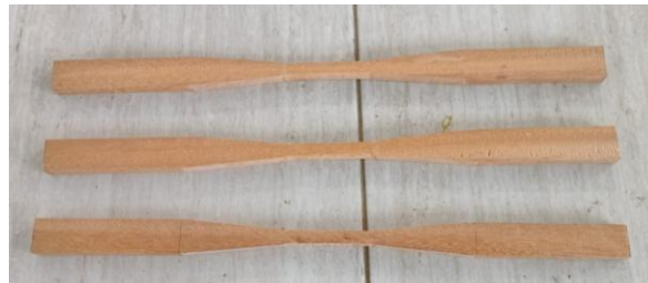
Gambar 3. Spesimen Kayu Sengon Laut
