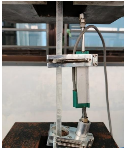
Gambar 14. Pemasangan Spesimen Epoxy Resin pada Mesin Uji Tarik
