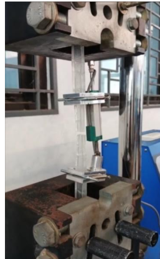
Gambar 15. Spesimen Epoxy Resin Mengalami Putus
