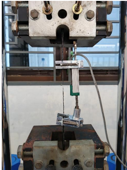
Gambar 11. Pemasangan Spesimen CFRP pada Mesin Uji Tarik
