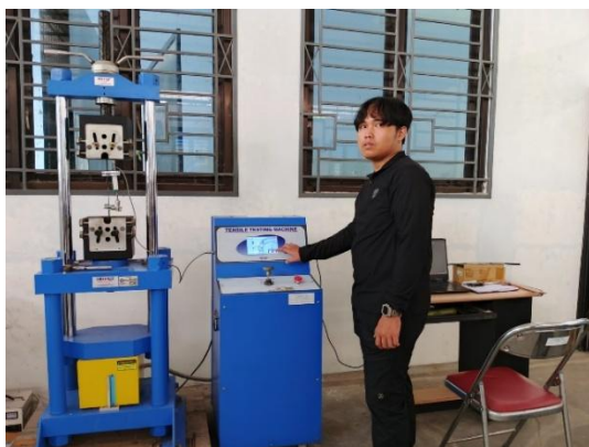
Gambar 1. Mesin Uji Tarik
