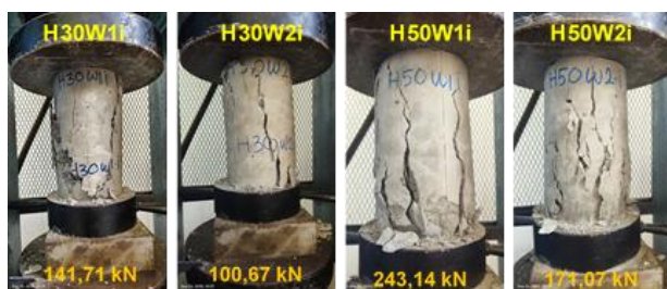
Gambar 6. Kegagalan spesimen berongga 30 MPa dan 50 MPa dengan filler Sumber: Kajian eksperimental (2025)
