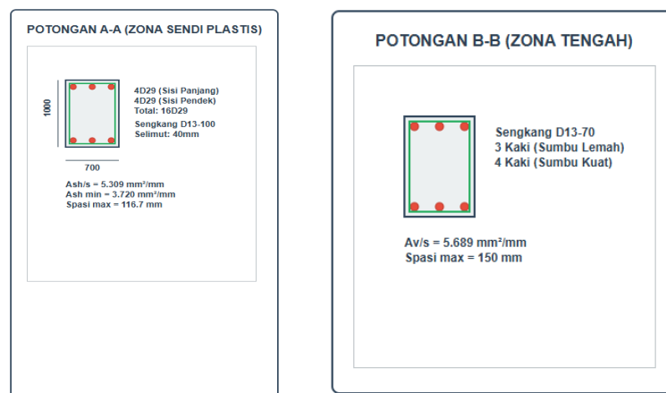
Gambar 10. Detailing Kolom Pot a, dan Pot b
