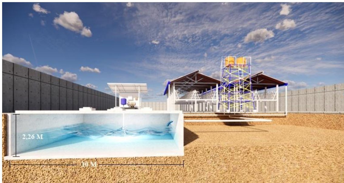
Gambar 6. Design Instalasi Pemanenan Air Hujan Sumber: Hasil Peninjauan, 2025
