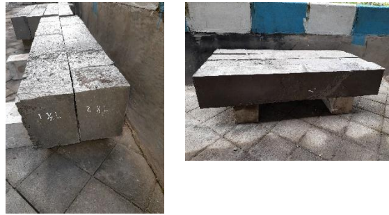
Gambar 5. Benda Uji Balok
