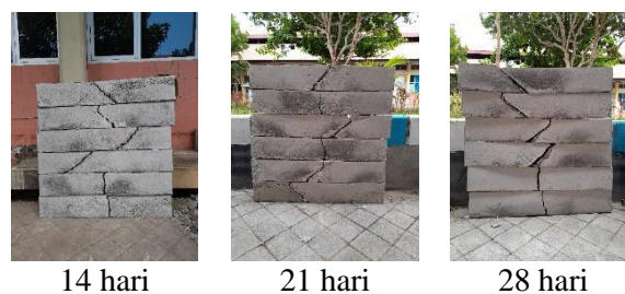
Gambar 8. Pola Patah Benda Uji Akibat Beban Lentur pada Berbagai Umur Beton
