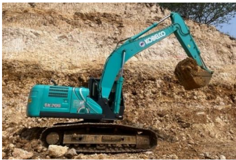
Gambar 1. Excavator Kobelco SK200 (sumber: dokumen pribadi, 2024)
