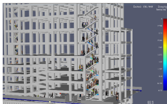
Gambar 16. Keseimbangan distribusi occupant menggunakan tangga evakuasi
