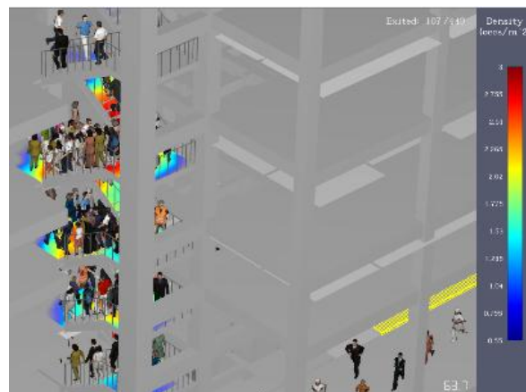
Gambar 13. Tumpukan pada tangga evakuasi 1
