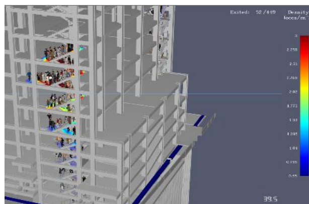
Gambar 15. Tumpukan pada tangga evakuasi 2
