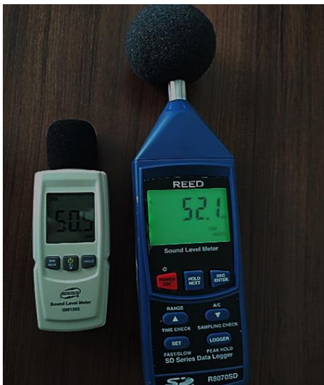
Gambar 8. Kalibrasi Alat Sound Level Meter
