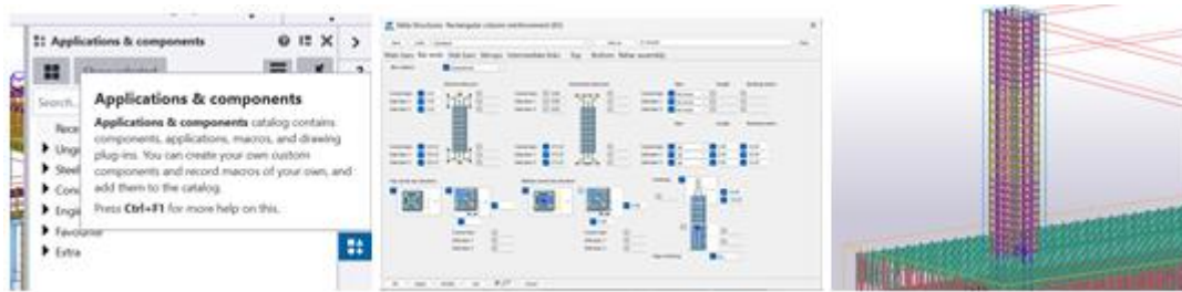
Gambar 5. Alur Pembesian Kolom Pedestal
