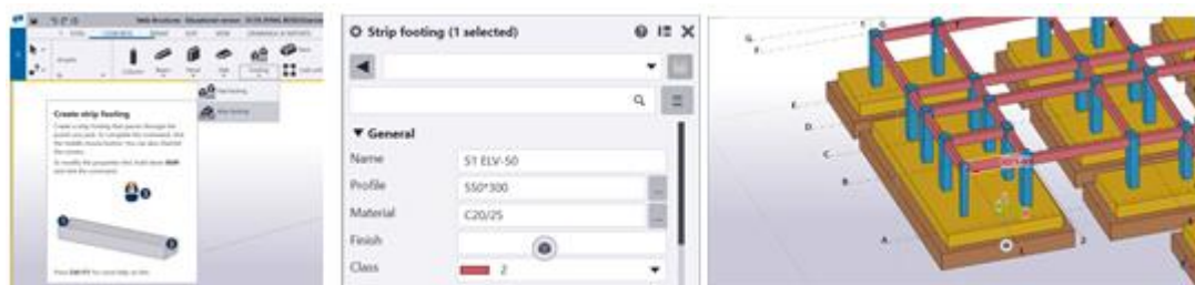
Gambar 6. Alur Pemodelan Concrete Sloof
