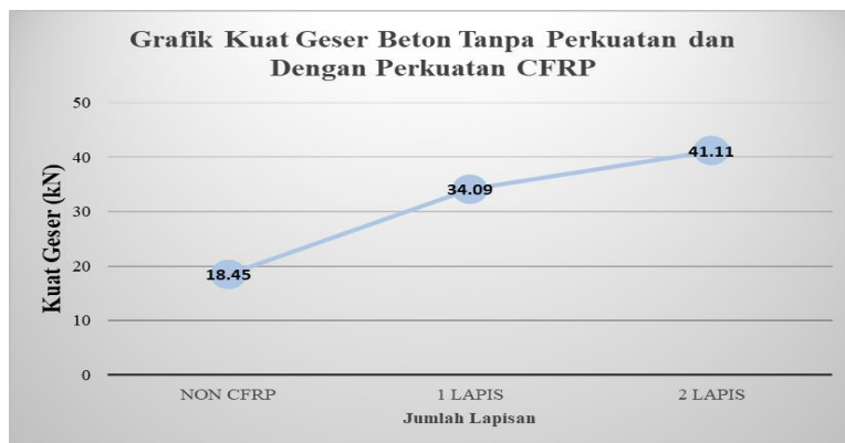
Gambar 4. Grafik Hasil Kuat Geser Tanpa Perkuatan dan Dengan Perkuatan CFRP Sumber: Data Olahan, 2024
