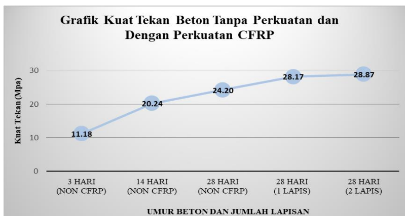
Gambar 1. Grafik Hasil Kuat Tekan Beton Tanpa Perkuatan dan Dengan Perkuatan CFRP
