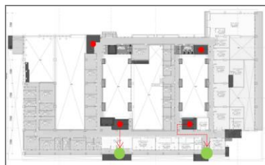
Gambar 19. Kondisi Eksisting titik Tangga Darurat
