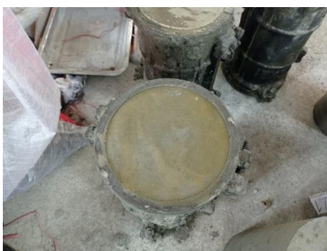
Gambar 6. Beton yang telah dicetak
