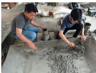
Gambar 5. Proses pengujian slump test beton.
