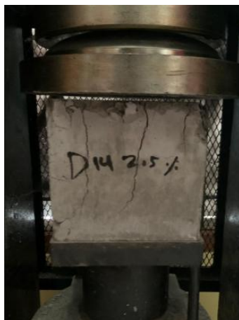
Gambar 5. Proses pengujian kuat tekan beton
