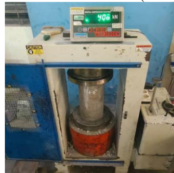
Gambar 2 (b). Beton dengan serat 0,02% Sumber : Data olahan (2025)
