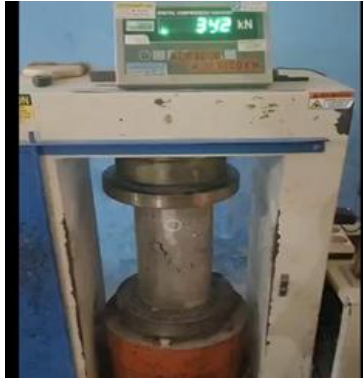
Gambar 2 (a). Beton tanpa serat Sumber : Data olahan (2025)
