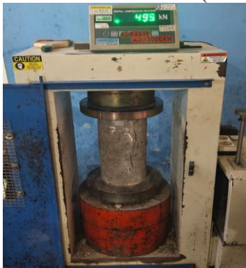
Gambar 2 (c). Beton dengan serat 0,04% Sumber : Data olahan (2025)
