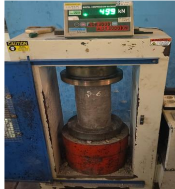
Gambar 2 (b). Beton dengan serat 0,02% Sumber : Data olahan (2025)
