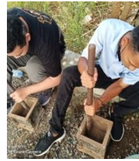
Gambar 7. Proses pengambilan sampel tanah
