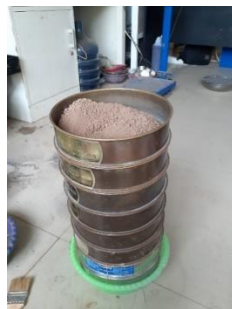
Gambar 8. Proses uji gradasi ayakan
