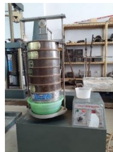
Gambar 8. Proses uji gradasi ayakan
